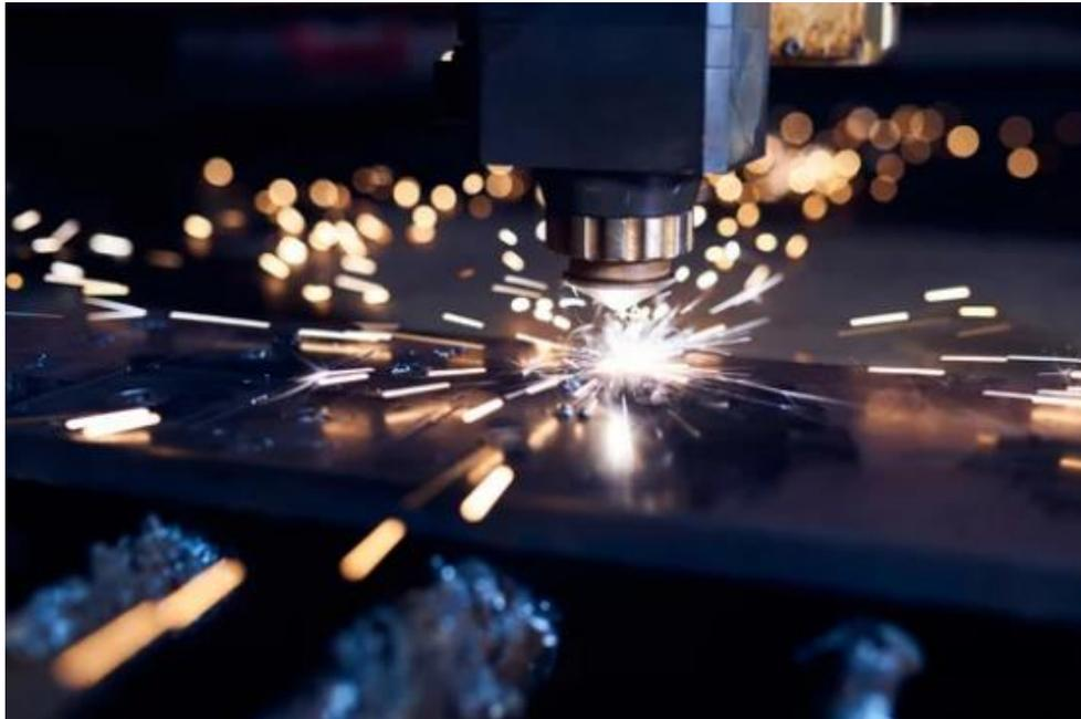
非接触型のレーザー加工はレーザー光をピンポイントに照射することで、工作物を融解しながら加工をするため、加工全体の時間がかかります。
